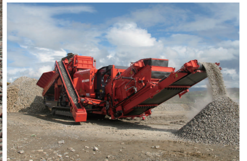
NFC1000RS应用于玄武岩破碎 NFC1000RS hard rock application
